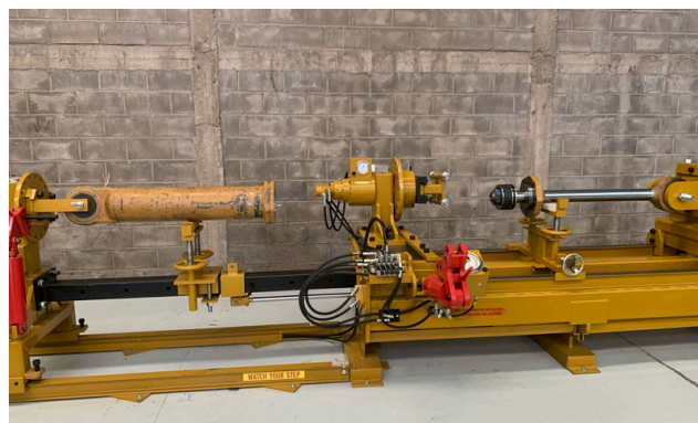
Proceso de desarmado de cilindro de dirección de cargador frontal Komatsu WA1200
